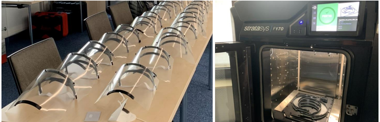
Leistete technische Unterstützung und praktischen Support: Das Schaufenster Fertigung und Automatisierungstechnologien (FuA) des KDH produzierte Face Shields für medizinische und pflegende Einrichtungen. Fotos: HWK für Oberfranken
